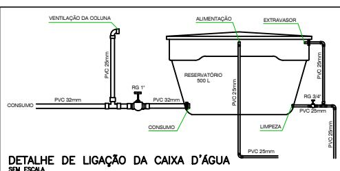
DETALHE DE LIGAÇÃO DA CAIXA D'ÁGUA
